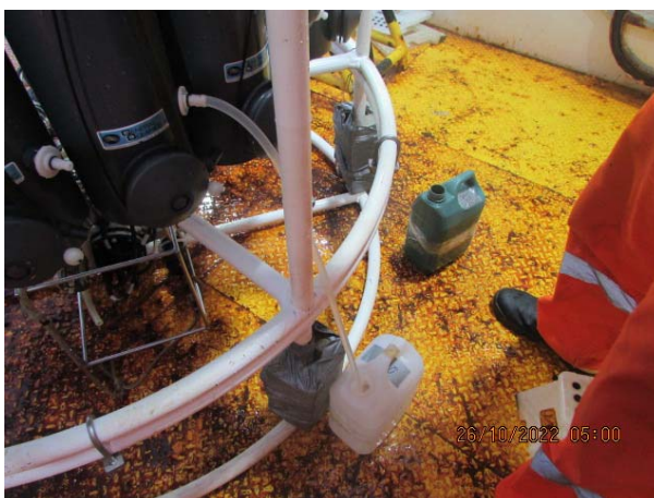
Figura IV.2.2-1 – Coleta das amostras de Material Particulado em Suspensão (MPS) a bordo.
