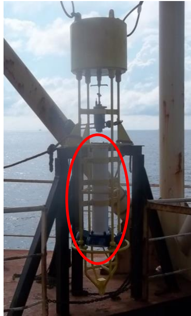
Figura 4: Sensor oceanográfico ADCP (circulado em vermelho).
