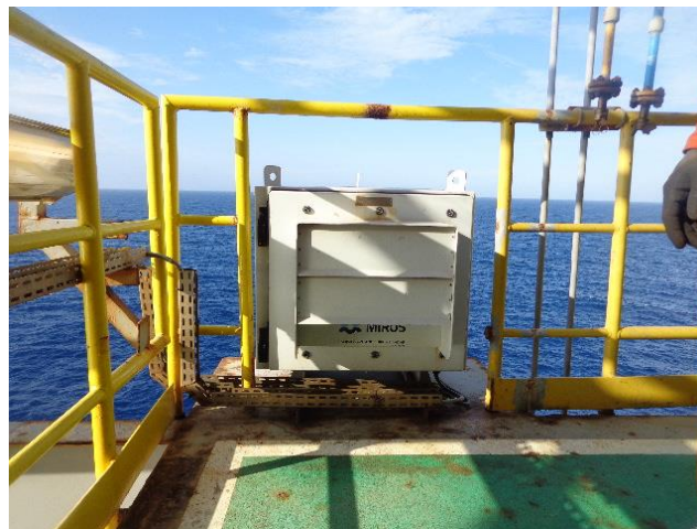
Figura 5: Radar de onda MIROS.
